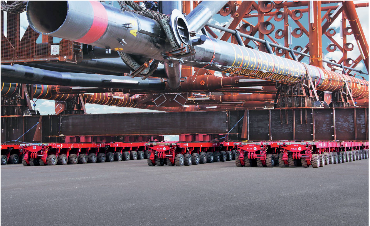
Siebzig Prozent aller Transporte über 3.000 Tonnen und neunzig Prozent aller Transporte über 5.000 Tonnen werden heute auf modularen, selbst angetriebenen Fahrzeugen der TII Group durchgeführt. Bild: TII Group
